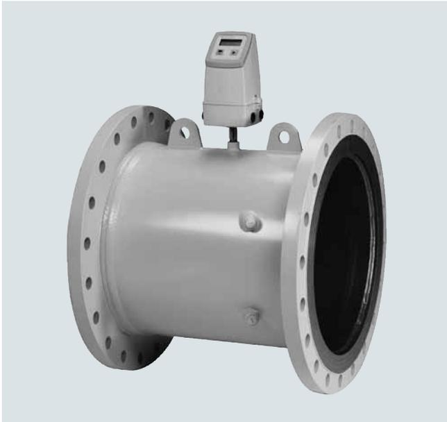
双声道流量计 SITRANS FUS380 由电池或交流电源供电。它可在区域供热设备，局域网，热源厂，换热站，制冷设备及其它常规水应用中测量水流。
