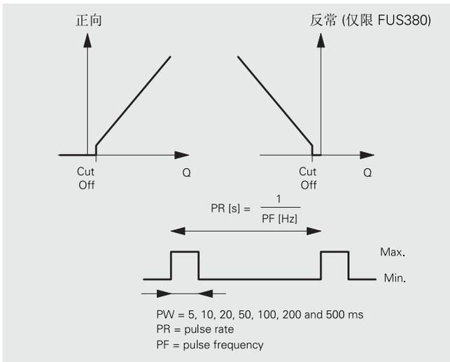
脉冲量：输出 A/B 设定了每个脉冲的量，计算前向流 / 反向流或前向净流 / 反向净流。每个脉冲量可自由设定（只适于 FUS380）。
