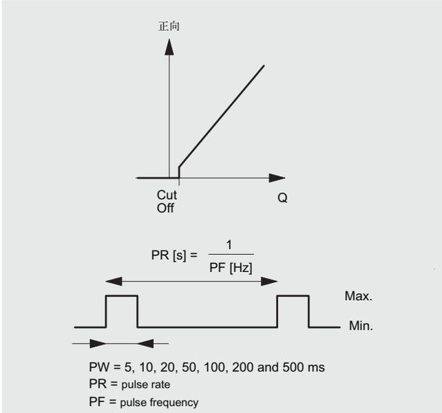
脉冲量：输出 A/B 设定了每个脉冲的量，计算前向流 / 反向流或前向净流 / 反向净流。每个脉冲量可自由设定（只适于 FUS380）。
