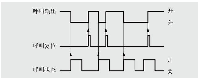
呼叫：呼叫输出一直激活直到通过 PC 程序手动重置。报警触发时，呼叫功能也被启动。
