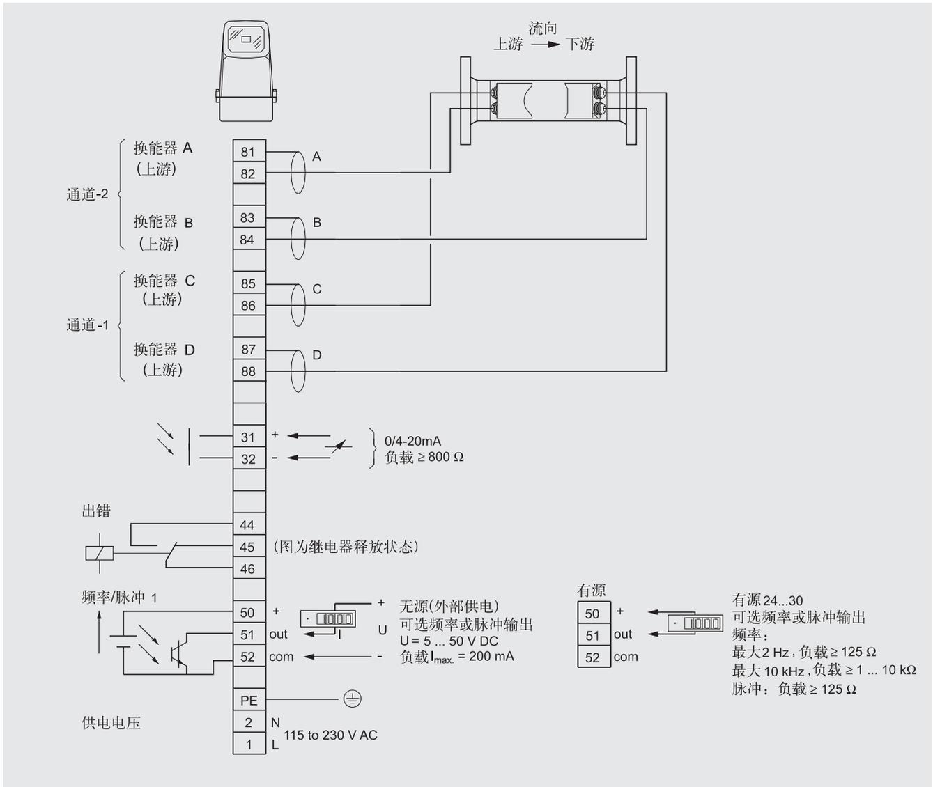
SONO 3000/3300 CT (IP67 (NEMA 4X/6) 型), 电气连接
