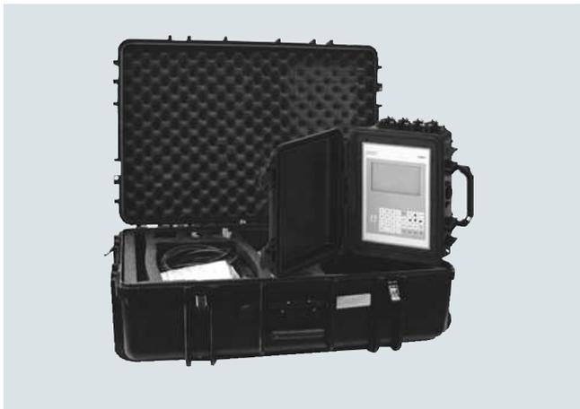
广泛用于水和污水的测量或对其它大口径管道流量仪表的核查。
