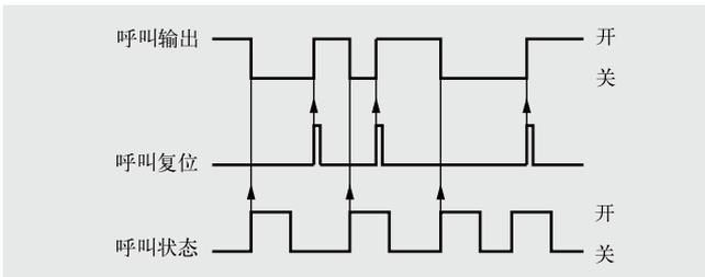
呼叫：呼叫输出一直激活直到通过 PC 程序手动重置。报警触发时，呼叫功能也被启动。
